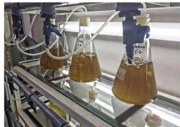
**Figura 22.** Manejo de cepas para el desarrollo de cultivos intermedios de microalgas para el sistema de producción masiva de bajo costo.
