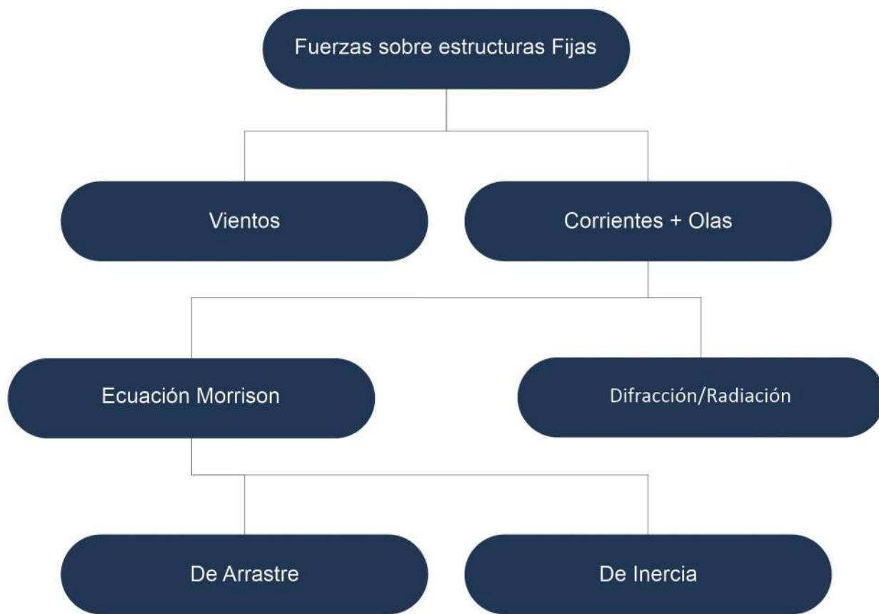
*Figura 28. Principales fuerzas incidentes sobre estructuras fijas en el mar.*
