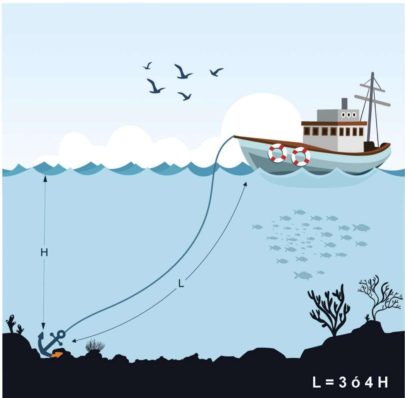
Figura 34. Relación profundidad de la embarcación.
