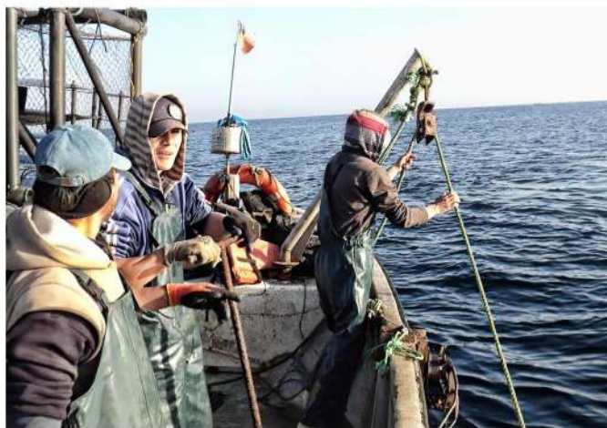
Figura 35. tirada de araña pescante: un tripulante hace el lance del pescante, para capturar la línea de cultivo, con el fin de trasladar a los roletees de la embarcación todo esto apoyado por el huinche de la embarcación de cultivo.
