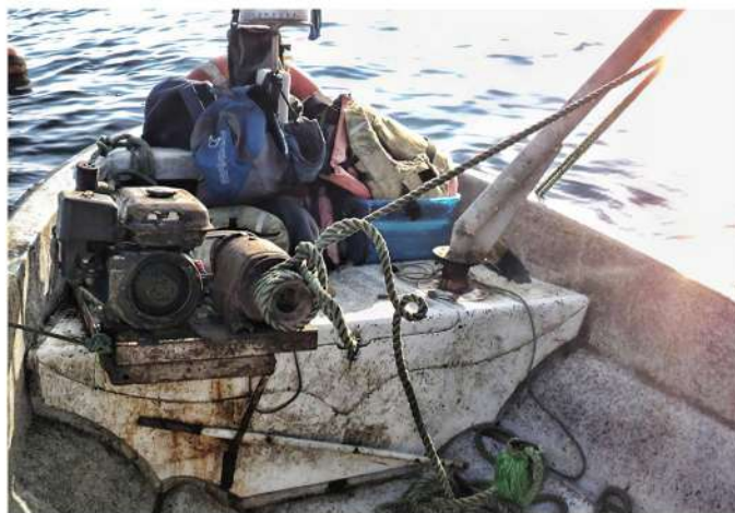
Figura 35. tirada de araña pescante: un tripulante hace el lance del pescante, para capturar la línea de cultivo, con el fin de trasladar a los roletees de la embarcación todo esto apoyado por el huinche de la embarcación de cultivo.
