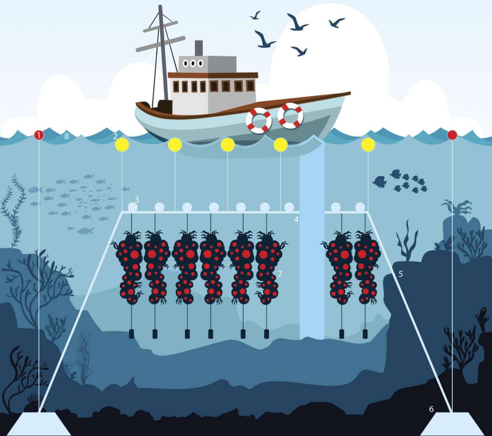
Figura 12. Sistema Long line: (1) Boya demarcadora de fondeo. (2) Boyas demarcatorias. (3) Boya sustentadora (4) Línea madre. (5) Línea de fondeo. (6) Fondeo. (7) Sistema de cultivo: cuelgas. (8) Superficie del mar.
