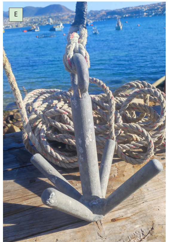
Figura 8. Equipamiento necesario para las tareas del cultivo donde se muestran (A) Rolete sosteniendo línea madre, (B) Winche, (C) Burro o pescante, (D) Espátulas para limpiado de boyas y (E) Araña galvanizada.
