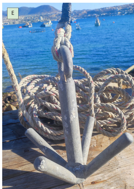
Figura 7. Equipamiento necesario para las tareas del cultivo donde se muestran (A) Rolete sosteniendo línea madre, (B) Winche, (C) Burro o pescante, (D) Espátulas para limpiado de boyas y (E) Araña galvanizada.
