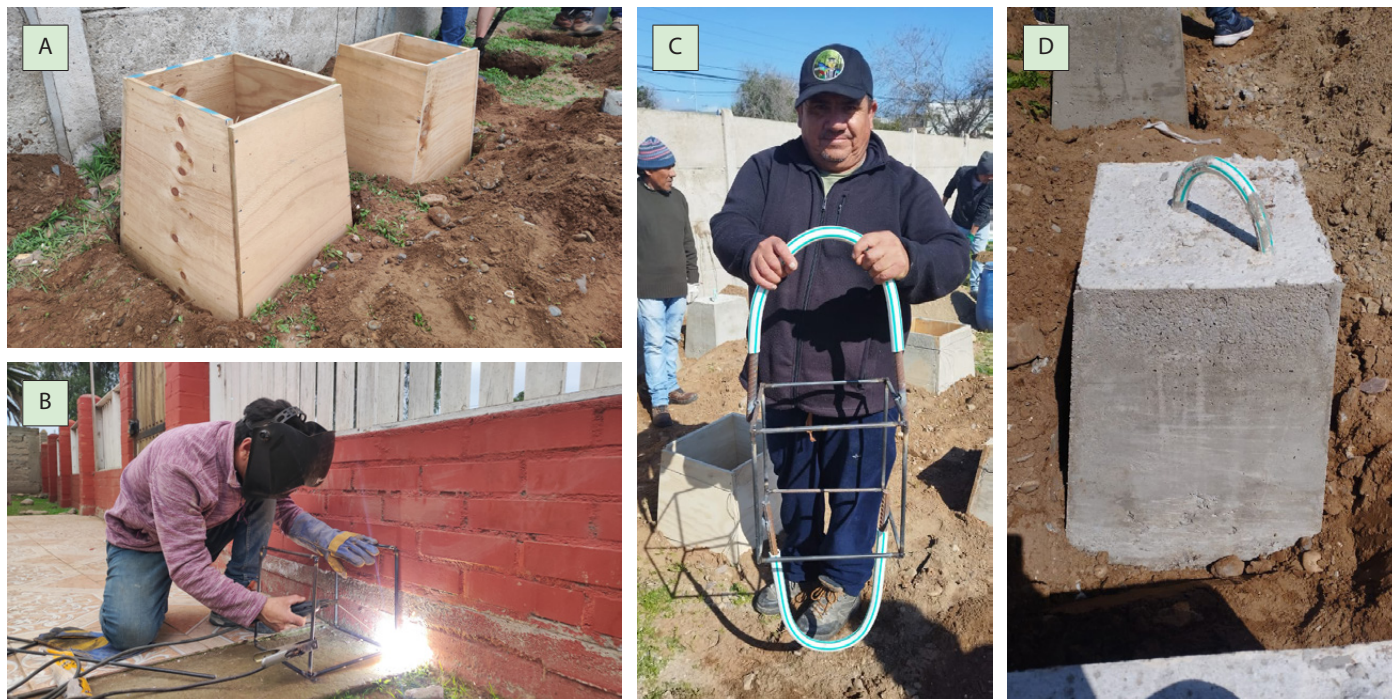
Figura 5. Confección de sistemas de fondeo, donde se muestran los moldes para la estructura (A), confección de armazón para soporte interno del fondeo (B), armazón más orejas para atar los fondeos a la línea madre y al tren de fondeos (C) y fondeo al término de la confección (D).
