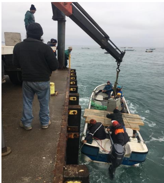
Figura 34: Brazo hidráulica para carga de muertos de fondeo.
