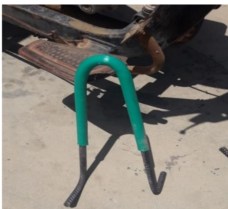
Figura 28: Oreja a instalar en muerto de fondeo.
