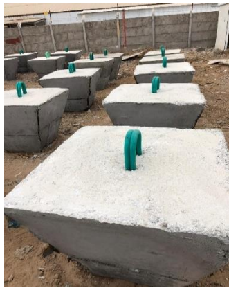
Figura 05: Muertos o fondeos de concreto.
