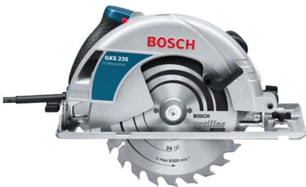
Figura 24: Sierra circular: La sierra circular es una máquina para aserrar longitudinal o transversalmente madera, metal, plástico u otros materiales. Está dotada de un motor eléctrico que hace girar a gran velocidad una hoja circular.
