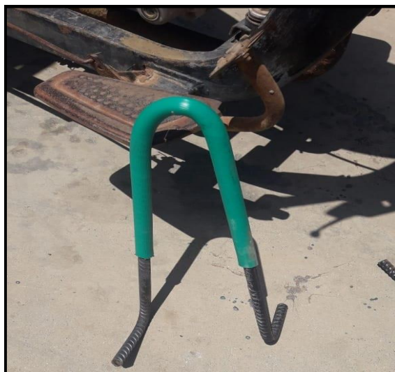
Figura 19: Oreja metálica, recubierta con manguera de 1”.
