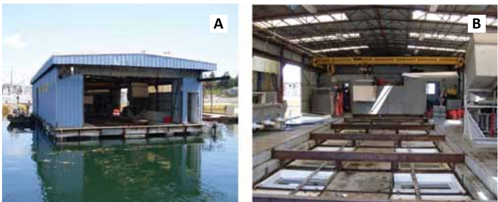
Figura 4. (A) Vista externa de um FLUPSY com cobertura; (B) vista interna de um FLUPSY coberto, com uma ponte hidráulica para manejar os tanques com sementes de ostras Fotos: Felipe Matarazzo Suplicy
