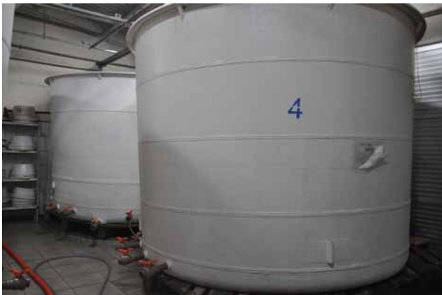
Figura 4. Tanques de fibra de vidro (20.000L) utilizados na larvicultura de ostras com sistema de cultivo estático
