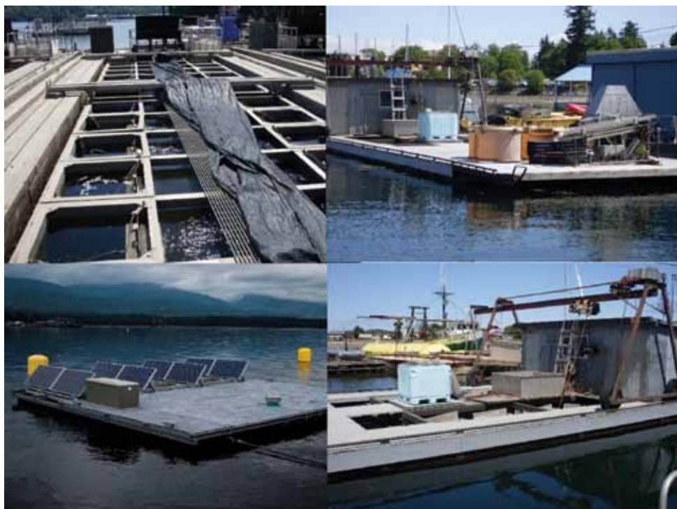
Figura 5. Exemplo de FLUPSY sem cobertura, construídos em madeira e com tanques de alumínio naval, e com energia fotovoltaica
