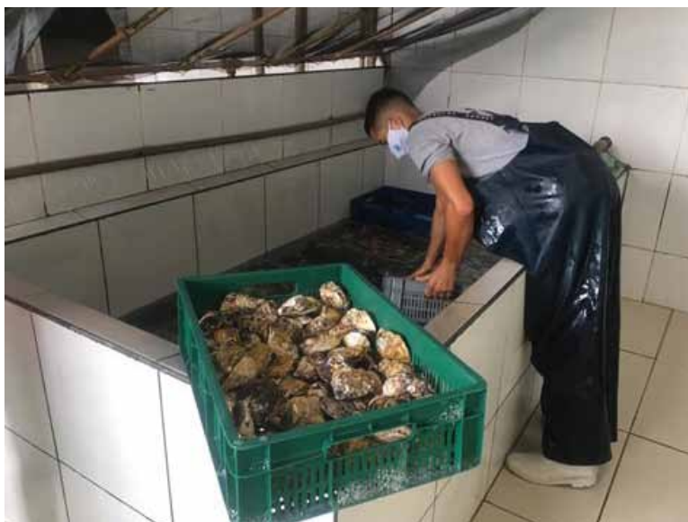
Figura 7. Tanque de depuração de média escala com volume de 4.000L e capacidade para 70 caixas vazadas, cada uma com 10 dúzias de ostras (total de 700dz.). Em primeiro plano está uma caixa vazada com ostras
