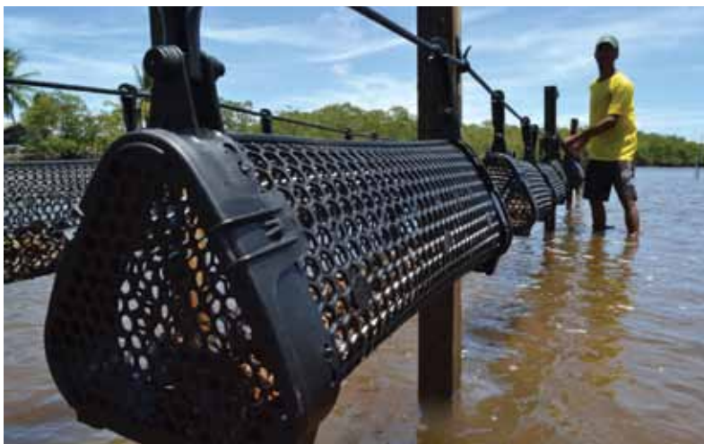
Figura 9. Sistema de cultivo de ostras com longline ajustável BST. No primeiro plano está um cesto removível, instalado no cabo plástico monofilamento. A imagem mostra também as estacas de madeira que sustentam o cabo e o grampo elevador do cabo fixado na estaca. Cultivo localizado em Indiaroba, SE
