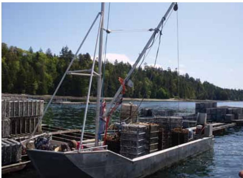
Figura 21. Barco de alumínio equipado com pau de carga e guincho elétrico para a movimentação de pilhas de bandejas com ostras Foto: Felipe Matarazzo Suplicy
