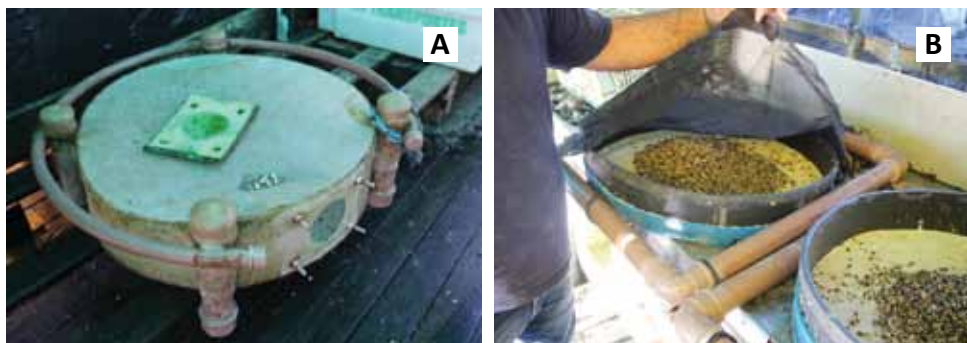
Figura 9. (A) Cilindros berçários confeccionados em fibra de vidro; (B) com seções cortadas de um galão plástico de 200L
