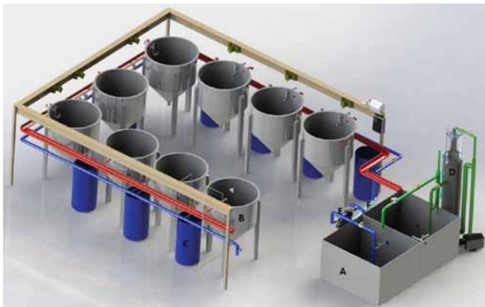
Figura 7. Desenho esquemático de um sistema de recirculação para larvicultura de moluscos: (A) tanque pulmão ou “ sump ”; (B) tanques cilindro-cônico para larvicultura; (C) tanques de drenagem; (D) filtro “ skimmer ”; (E) filtro mecânico de disco; (F) linha de abastecimento com água tratada Foto: Caique Sales de Miranda Gomes
