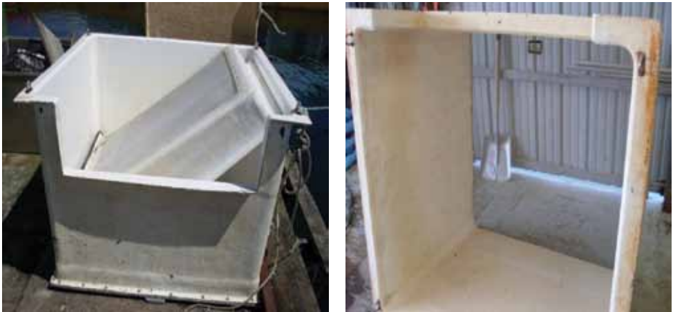
Figura 3. Exemplos de tanques comumente empregados em Floating Upweller System (FLUPSY) Fotos: Felipe Matarazzo Suplicy
