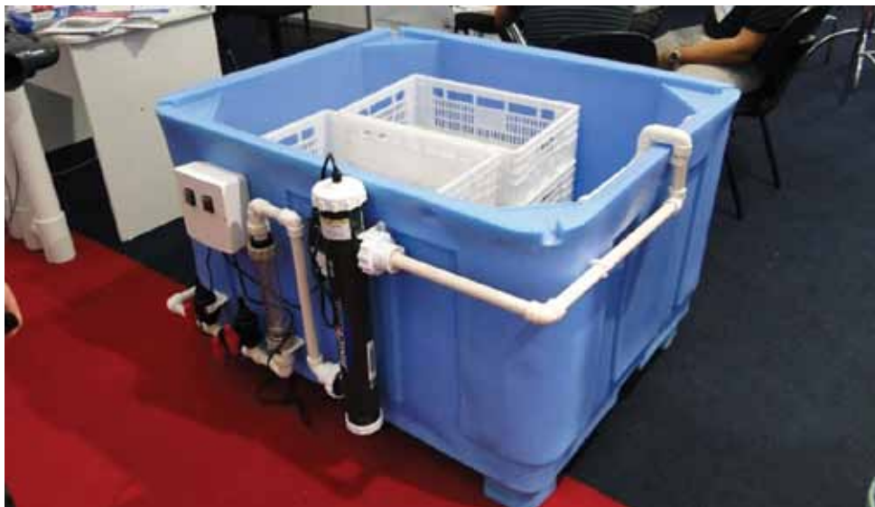
Figura 6. Depuradora de pequena escala com tanque de 660 litros, para depurar até 60 dúzias de ostras
