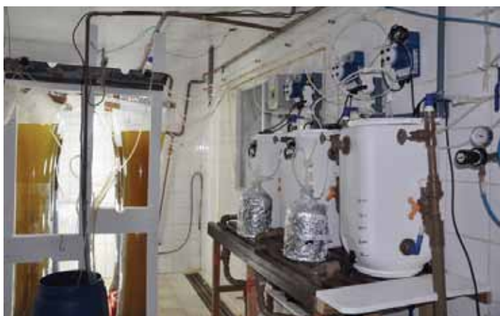
Figura 14. Sistema contínuo para produção de microalgas em laboratórios de reprodução de moluscos Foto: Laboratório de Moluscos Marinhos – LMM/UFSC
