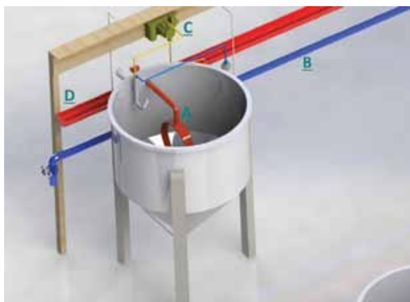
Figura 8. Detalhes do sistema de recirculação para larvicultura de moluscos: (A) banjos para evitar o escape de larvas de ostras; (B) linha de abastecimento com água tratada; (C) entrada de alimento com bomba dosadora; (D) calha de recebimento do efluente do tanque de larvicultura Foto: Caique Sales de Miranda Gomes
