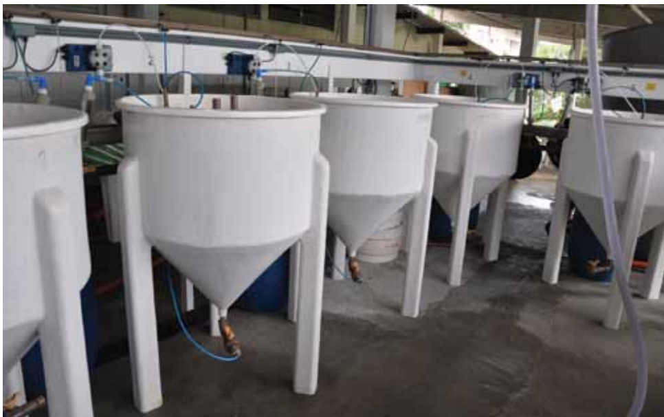
Figura 6. Tanques cilindro-cônicos de 250L utilizados em larvicultura de alta densidade com sistemas de fluxo contínuo, semicontínuo e recirculação de água
