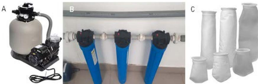
**Figura 15.** Filtros empleados en el *hatchery* del LICMA: A) arena, B) filtros de polipropileno y C) bolsas de poliéster
