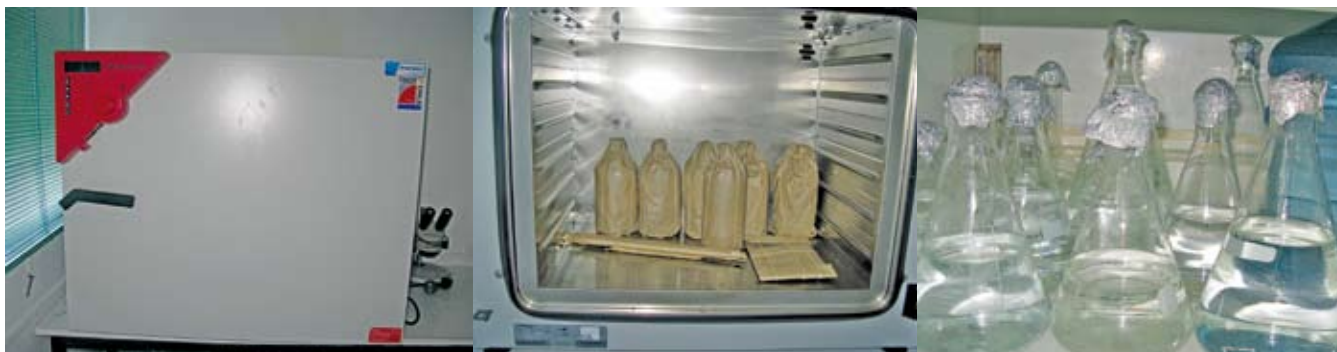
Fig. 8. Secuencia de manejo de matraces en estufa de secado.
