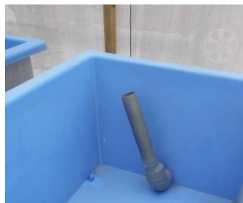
Fig. 12. Salida de estanque “pipa”.
