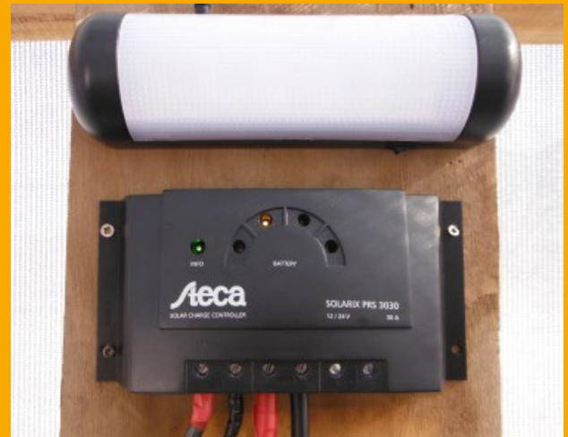
Fig. 19. Regulador de carga eléctrica.
