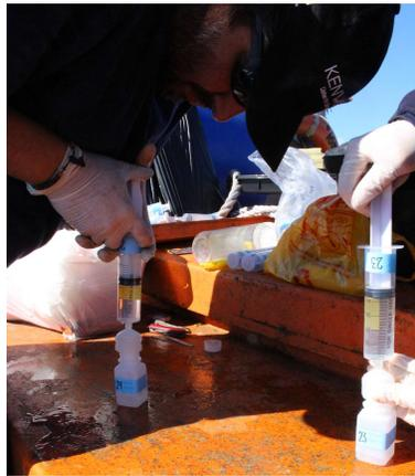
Figura 5. Proceso de filtrado de agua *in situ* para el an3lisis de nutrientes.
